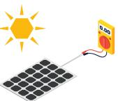
THE TEST IS ONLY VALID IF INCLUDING ALL PRECONDITIONS: A) MIDDAY **B) NO CLOUDS** C) NO SHADOWS **D) ONLY MULTIMETER** CONNECTED
